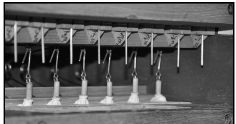
Restaurierte Windlade - geöffneter Windkasten mit neuen Lederpulpeten
